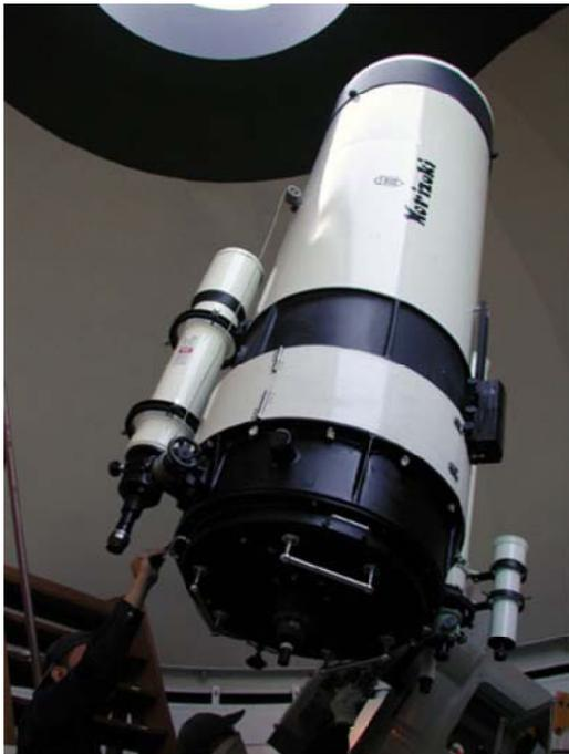
口径60㍎の大型反射望遠鏡
